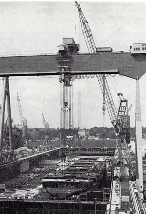
Während der 900-t-Portalkran die dritte 570-t-Großsektion im vorderen Schiffsbereich zur Montage absetzte, wurde mit Hilfe des 300-t-Portalkrans 8 eine Hecksektion eingerichtet.
