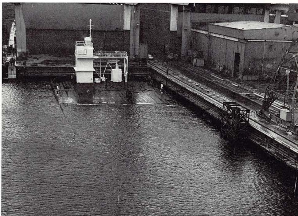
Bilder rechts: Absenkversuch des Leichters „FAIRALP 3“
