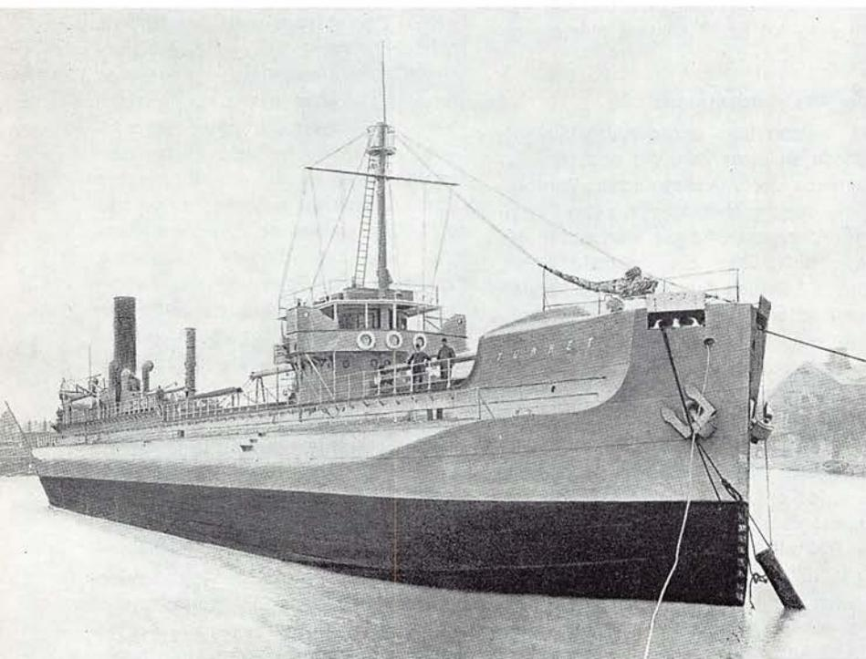
Der Dampfer „Turret“ (1892 bis 1900) L = 85,8 m, B = 11,6 m, H = 6,2 m; 1970 BRT.
