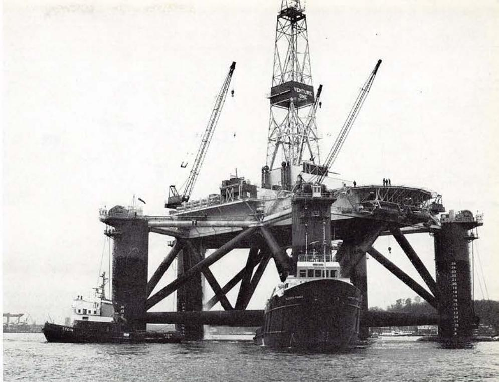
Sie wird mit einer Schleppgeschwindigkeit von 3,5 bis 4,5 kn zum Einsatzort gebracht und gegebenenfalls umgesetzt. Am vorgesehenen Arbeitsort wird sie freischwimmend von zehn 15-t-Ankern
