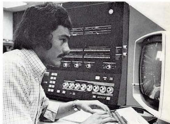
Zentraleinheit mit Bedienungspult und Bildschirmkonsole. Der Konsoloperator Uwe Lippert steuert den Ablauf des Mehr-Programm-Betriebes am Bildschirm.
