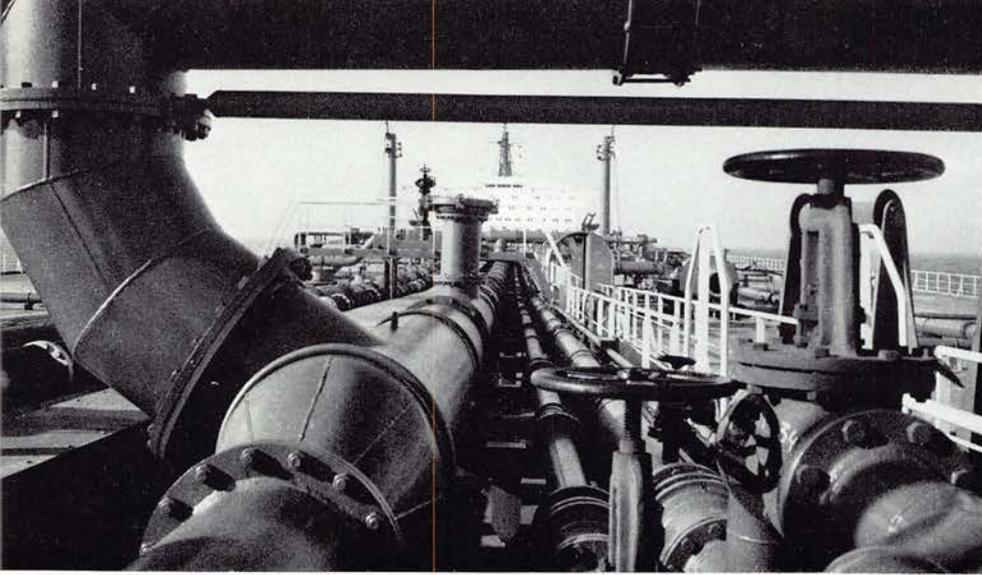
kammern im quergestellten Deckshaus. Eine Inertgasanlage pumpt gewaschene Kesselabgase auf die Ladung, um die Explosionsgefahr auf ein Minimum zu reduzieren.
