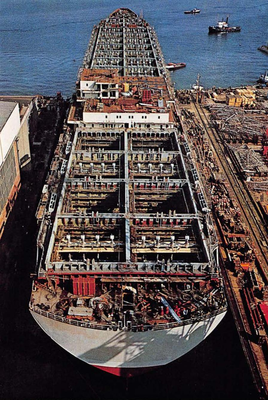
Containerschiff „Benalder“ beim Aufschwimmen und Kesseleinbau. Linke Seite: Blick in den fertigen Maschinenraum.
