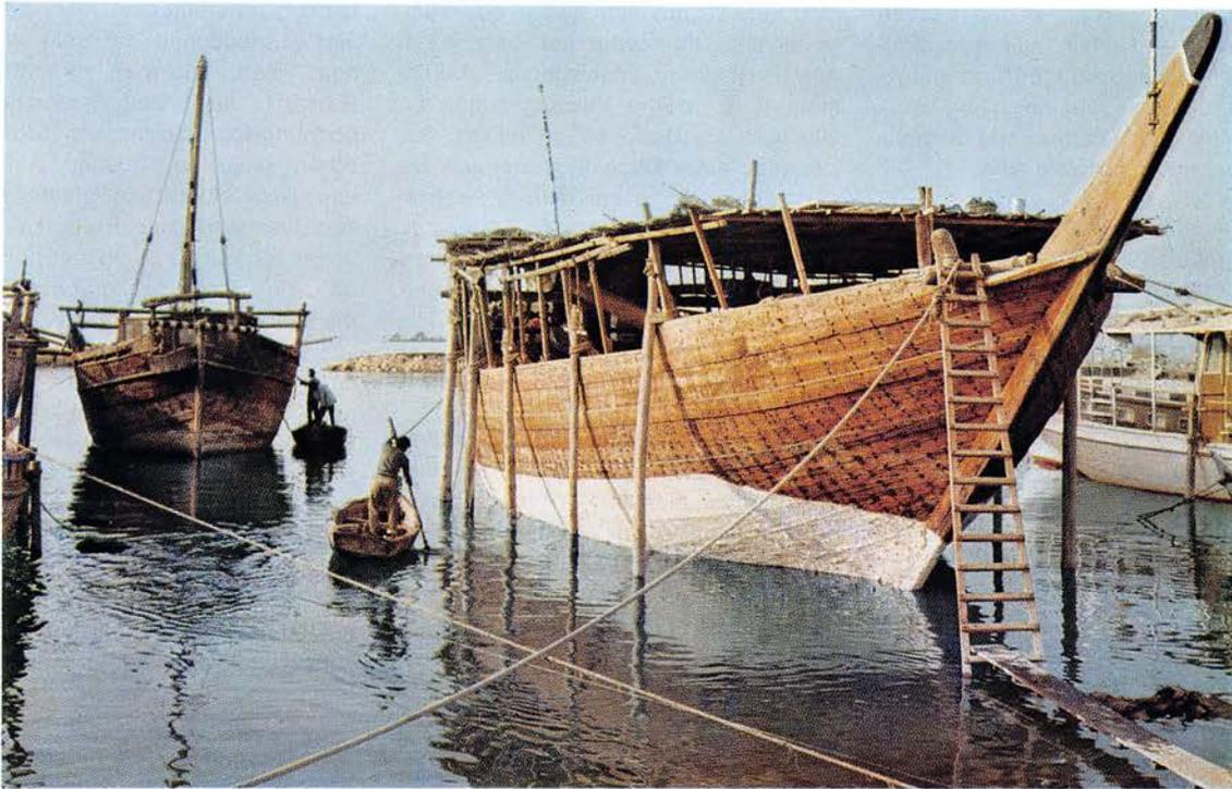
tüchtig. Im Falle einer Grundberührung ist eine Reparatur weniger kostspielig als bei einem stählernen Schiff. Kosten für Aufslippen oder Eindocken entfallen, Schäden am Schiff können in einfacher Zimmermannsarbeit beseitigt werden. Vor allem aber ist die Dhau sozusagen „pflegeleicht“. Sie benötigt keine teuren Ölfarbe-Anstriche. Sie wird nur gelegentlich mit Walöl oder Fischöl überpinselt und ist damit sogar gegen den Bohrwurm immun.
