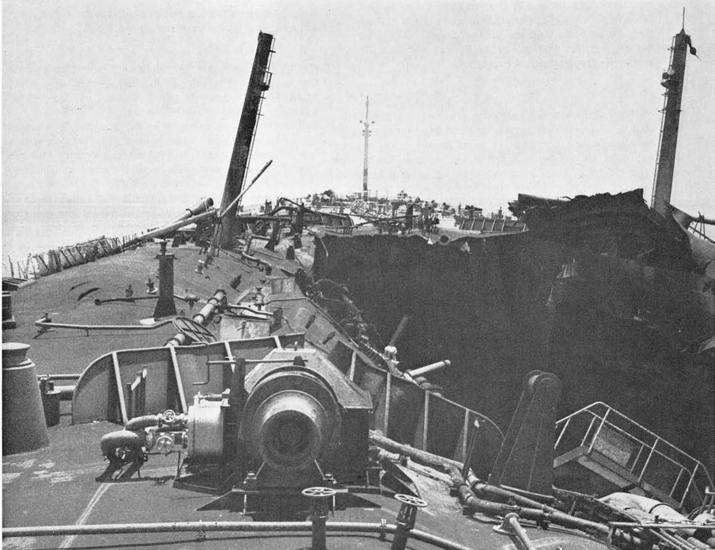
Während dieser Reinigungsoperation verändert sich die Zusammensetzung des Gasgemisches, also das Verhältnis von Luft zu Öldämpfen, so daß bei einer Entzündung eine Explosion möglich ist.
