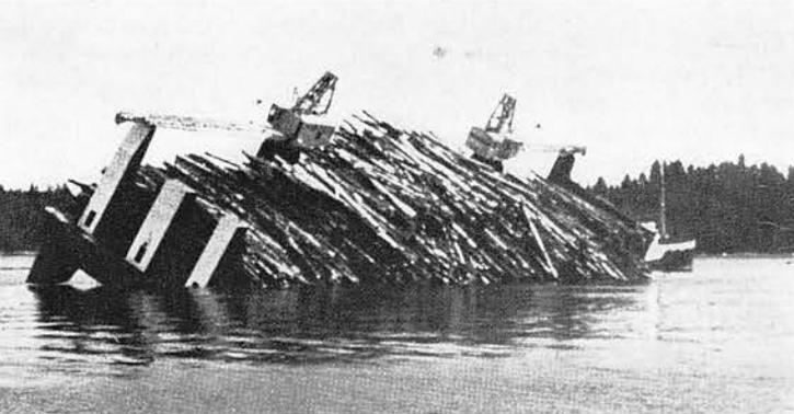
Abbildung 2: Krängung eines Holz-Carriers unmittelbar vor „dumping“.
