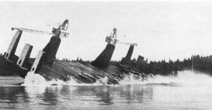
Abbildung 3: „Dumping“-Entladung eines kanadischen Holz-Carriers.
