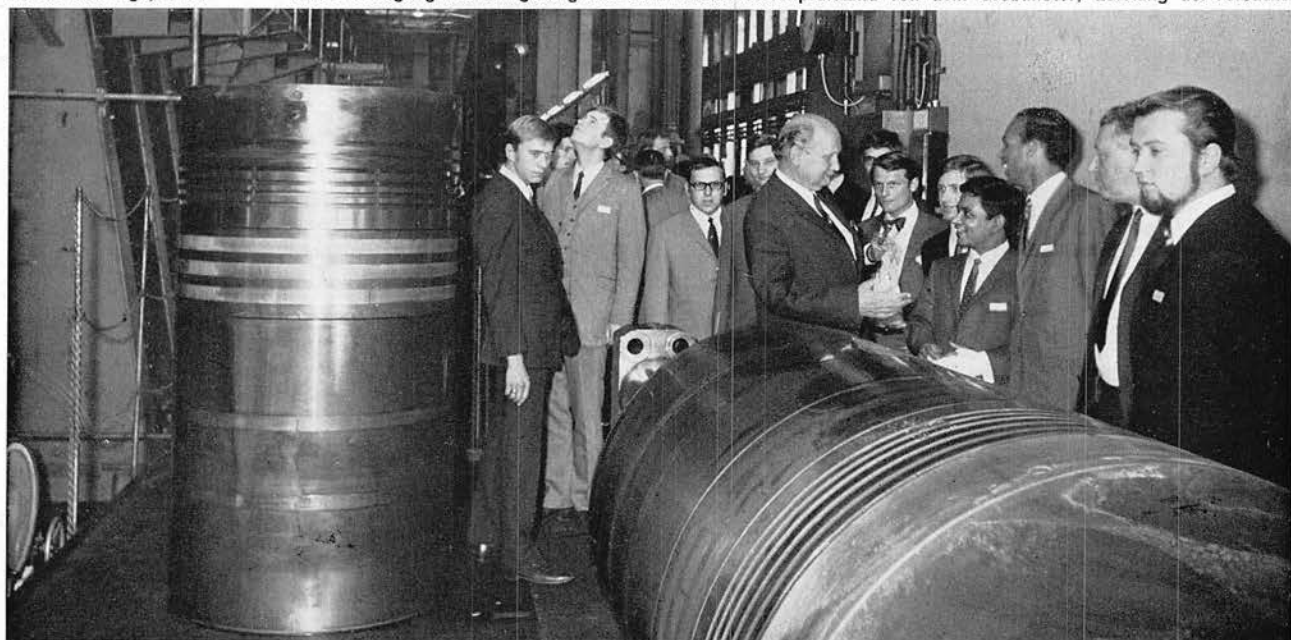
Mitte: Rundgang Werk Augsburg. Auf dem Dieselmotorenprüfstand von dem Größtmotor; Leistung der Versuchsmaschine (Kolbendurchmesser 102 cm, Kolbenhub 180 cm (bei 106 U/min je Zylinder Normalleistung 4000 PS, erreichte Höchstleistung 5130 PS.
