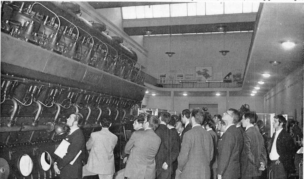
Mitte: Rundgang Werk Augsburg. Auf dem Dieselmotorenprüfstand von dem Größtmotor; Leistung der Versuchsmaschine (Kolbendurchmesser 102 cm, Kolbenhub 180 cm (bei 106 U/min je Zylinder Normalleistung 4000 PS, erreichte Höchstleistung 5130 PS.
