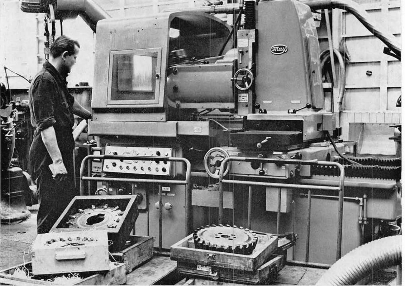
**10** Elektrolytische Messerkopfschleifmaschine M 1000
