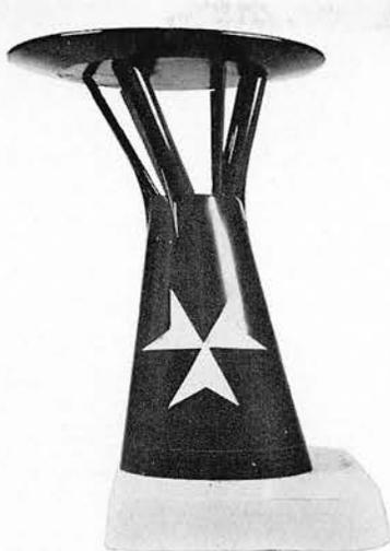
Eine kleine Auswahl der im Windkanal untersuchten Schornsteinmodelle. Die Skizze rechts zeigt die endgültige Ausführung.
