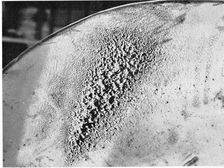
Örtlich begrenzte Kavitations-Erosion auf der Saugseite eines Flügels
