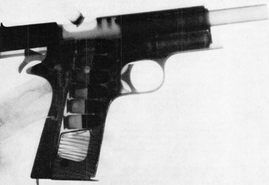
7 Schuß mit einer automatischen Selbstladepistole in einen Holzblock. Röntgenblitzaufnahme. Interessant ist das Hochschnellen der Pistole aus der Schußrichtung nach dem Abschuß. (Aufnahme: Field Emission Corp., Minnville, USA.)
