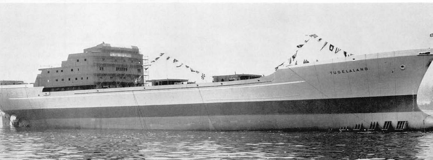
schiff vom Volldeckertyp mit Einrichtungen für zwölf Fahrgäste. Sieben wasserdichte Schotten teilen den Rumpf in fünf Laderäume. Die Maschine liegt zwischen Raum 4 und Raum 5. Das Schiff hat eine über den Laderaum 1 sich erstreckende lange Back und eine an das Brückenhaus anschließende Poop.
