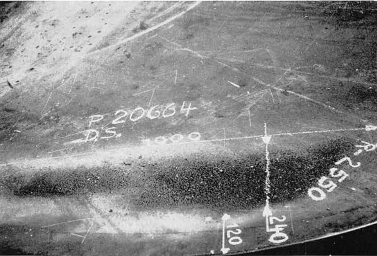
Kavitations-Erosionen auf der Druckseite eines Flügels
