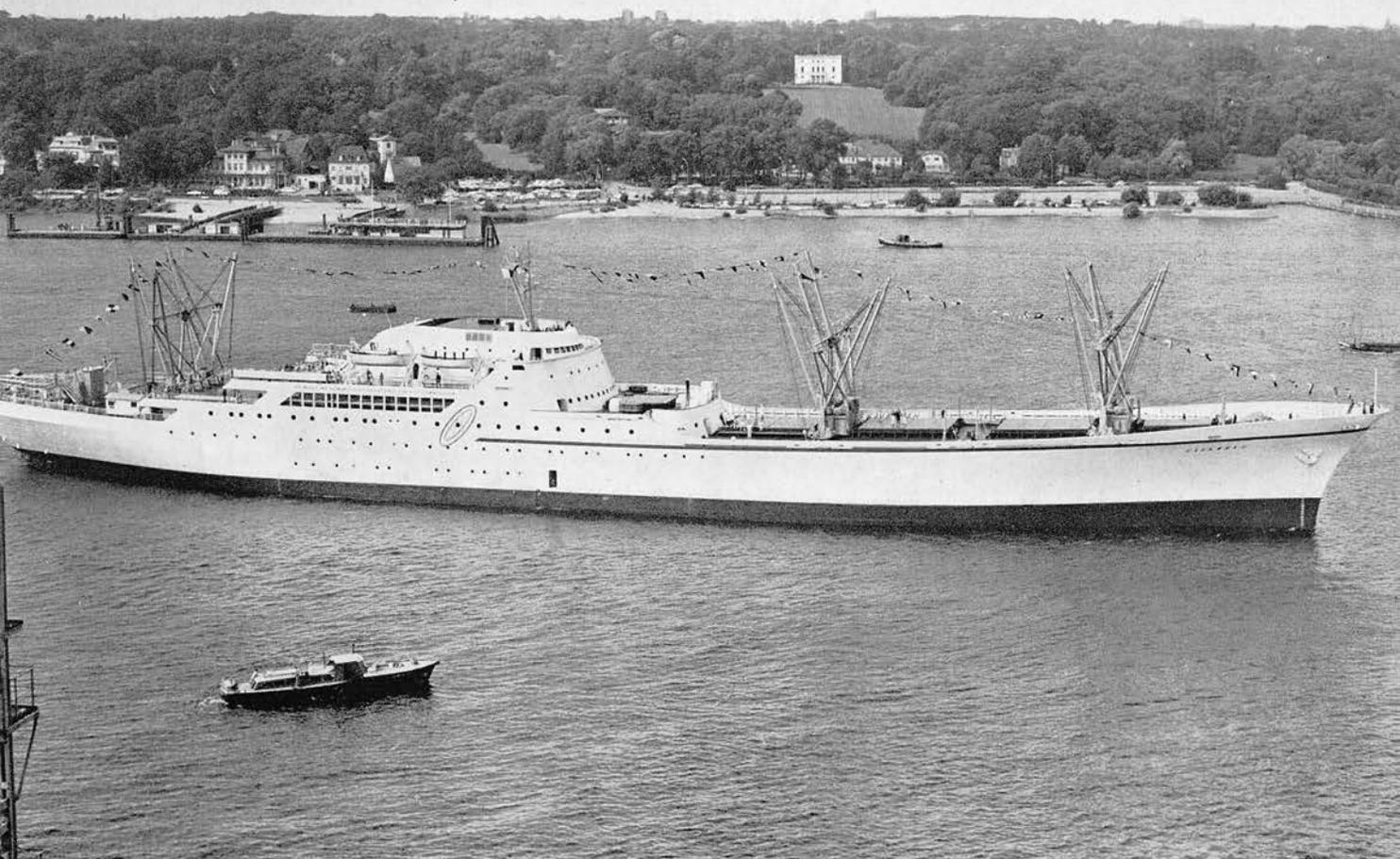
stung erreicht das 181,5 m lange, 23,77 m breite und 8,98 m tiefgehende Schiff eine Geschwindigkeit von 21 Knoten.
