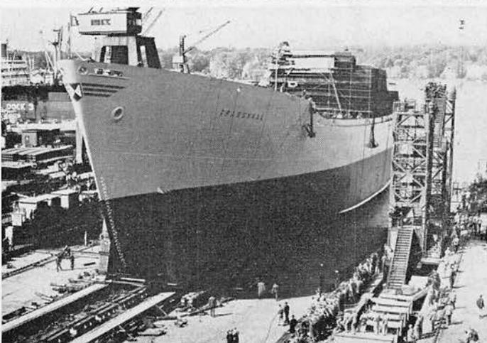
Auch dieses Schiff hat Einrichtungen für 12 Fahrgäste (vgl. Aufsatz S. 6 ff) und soll bei einer Maschinenleistung von 8400 PSe 17,5 Kn. laufen. Das Fassungsvermögen aller Laderäume beträgt etwa 725 000 cu.ft. für Schüttgut.
