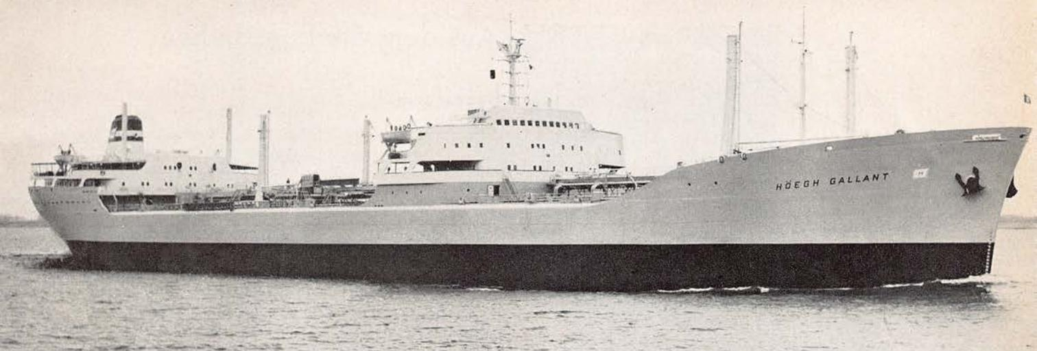
T.T. „Höegh Gallant“, 47 700 t Tragfähigkeit, 17,5 Kn., wurde vor genau einem Jahr abgeliefert . . .
