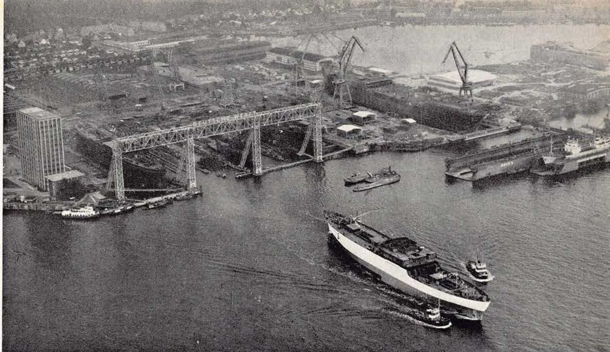
Am 28. Juni 1961 wurde das Motorschiff „USAMBARA“ seinem Eigner, der Reederei „Deutsche Afrika Linien“, übergeben. Das Schiff hat eine Tragfähigkeit von 10 380 t als Volldecker und 8400 t als Schutzdecker. Es verfügt über 6 Ladebäume mit je 10 t Tragkraft, zehn 5-t-Bäume und je einen Schwergutbaum von 40 und 25 t Tragkraft. Fahrgasteinrichtungen sind für 12 Passagiere an Bord.
