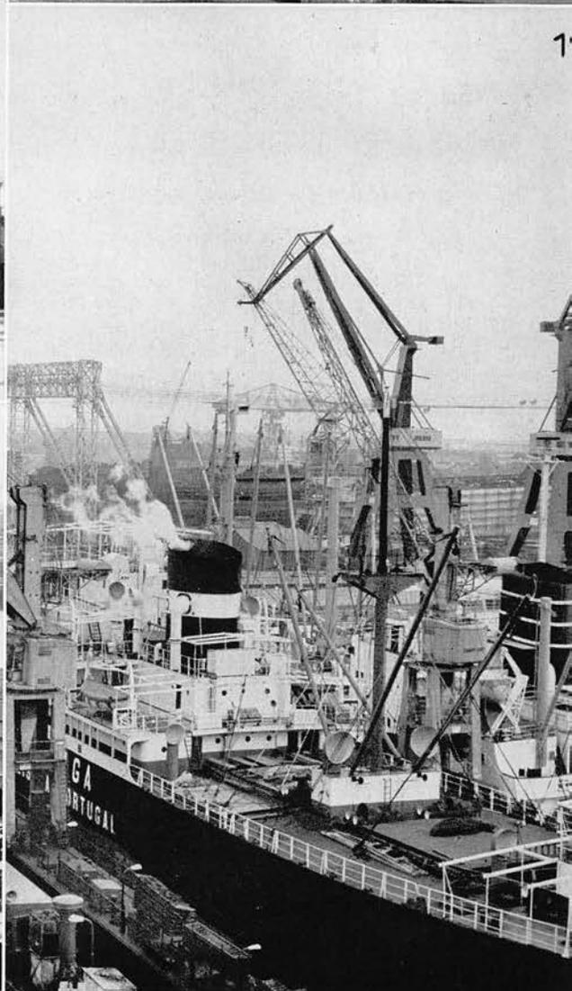
Abb. 15: Stapellau Motor-Tanker „Eberhart Essberger“, 19986 tdw, 15 kn
