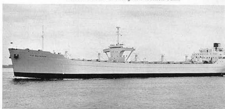
Erz- und Bauxit-Schiff der Rio Grande-Klasse von 36 000 t Tragfähigkeit
