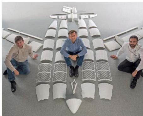
zusammenfügbar. Das schafft neue Spielräume; wir müssen das Flugzeug, wenn wir beispielsweise Leitwerke austauschen, nicht neu drucken«, erklärt Konigorski. Auch neue Flügel-Optionen kommen zum Einsatz. Zum Beispiel der gedruckte Hexagon-Flügel, der durch seine Stützstruktur, vergleichbar einer
