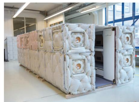
In »Watte« gepackt: Das Lower Deck Rest Compartment ist eine kompakte, mit Isomatten verkleidete Box, die normalerweise im Frachtraum installiert wird.
