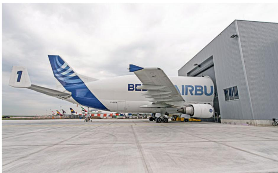
Flügel und Hinterteil müssen draußen bleiben. Rollende Tore mit einem Ausschnitt, der exakt die Kontur des Beluga-Rumpfs wiedergibt, umschließen am Andockbereich das Flugzeug. Beim Entladen in der Halle werden die Bauteile auf drei 35 m langen Schlitten, den sogenannten Mobile-Racks, bewegt und über einen Cargo-Boarder außerhalb der Halle zu den Ablagerampen transportiert.
