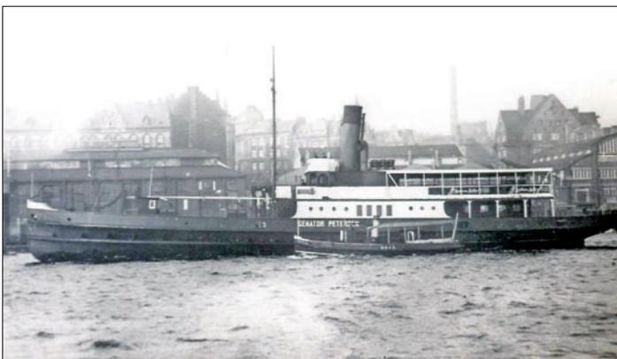
Als die Kapazität des Fährschiffes für den Werksverkehr zur Deutschen Werft nicht mehr ausreichte, wurde das Schiff 1922 auf der Deutschen Werft im Werk Tollerort um 10m verlängert. Das Schiff erhielt aus ästhetischen Gründen einen zweiten Schornstein, der aber keine Funktion hatte.
