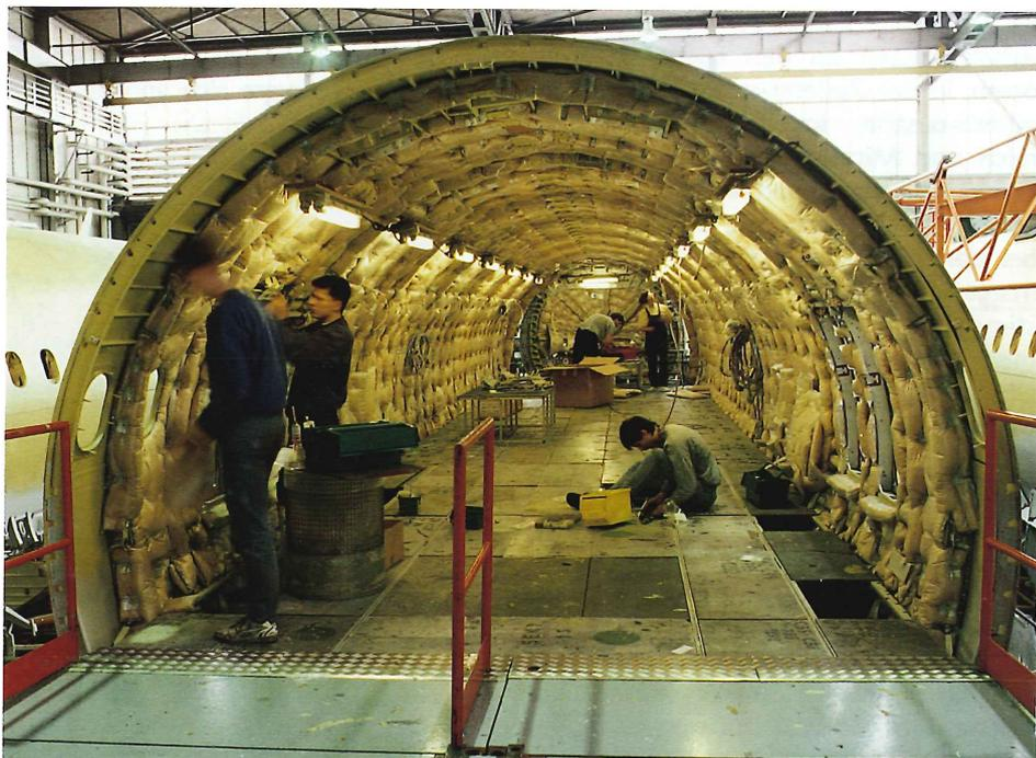
*Das Rumpfheck, das größte zusammenhängende Bauteil der Airbus-Flugzeuge, wird komplett bei Airbus in Hamburg montiert, mit allen flugwichtigen Systemen versehen und danach funktionsgeprüft an die Endmontage übergeben.*
