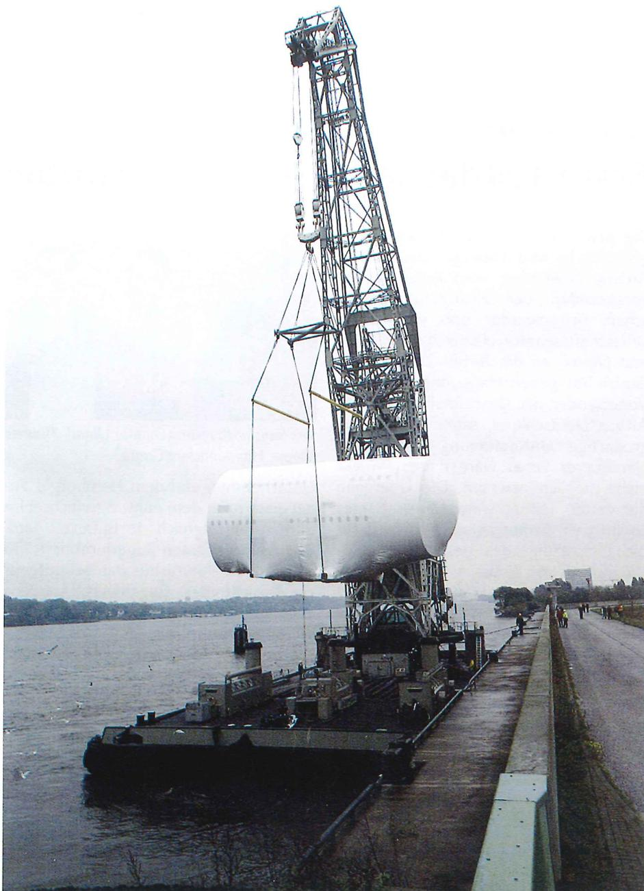
Ein dicker Fisch am Haken: Der Schwimmkran HHLA bringt die 18 m lange Rumpfsektion zum Werk Hamburg-Finkenwerder.
